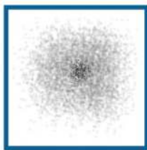
Rapporto di diluizione errato. Troppo diluente può produrre questa superficie dall'aspetto polveroso
